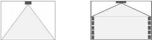
Figura 430. 1 B) Efecto del diseño de la luminaria en del Coeficiente de utilización (CU) para un local dado.
